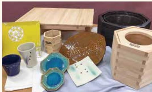
**陶芸作業** 粘土を均一な厚さにして、部品を組み立てる「たたら成形」で製品を作ります。平面の皿から始まり、立体的な製品へと発展し、焼きや施釉の作業も行います。
